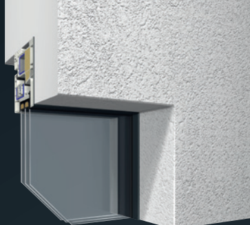
Laibungsvariante mit verdeckt liegenden Fensterrahmen
